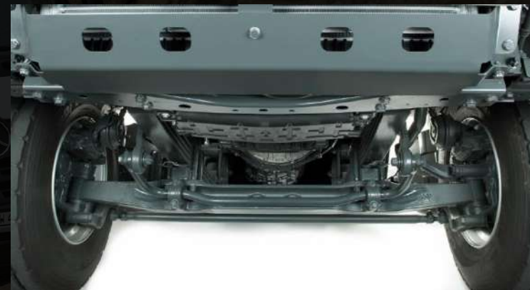
Прямая балка с высоким дорожным просветом (A1X)
