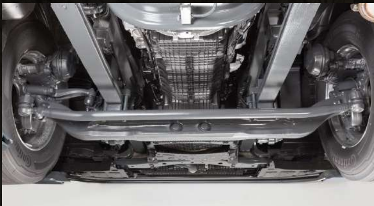
Выгнутая передняя балка (A1Z)
