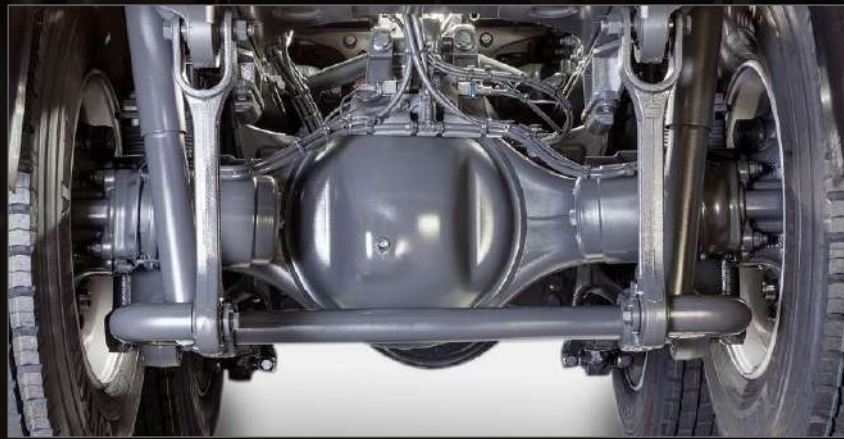
Ведущий мост с планетарными колёсными редукторами
